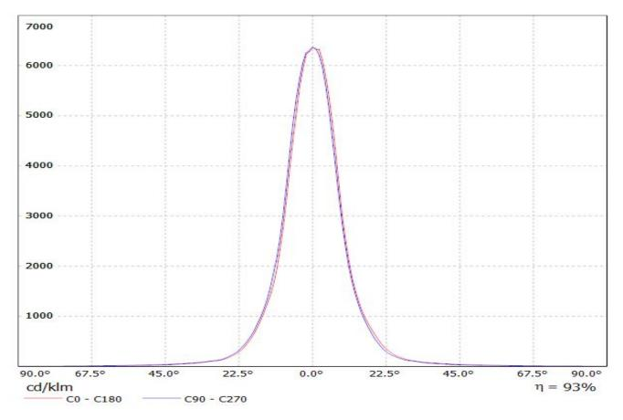
Luminaire: LEDiL Oy C12041\_EVA-S\_(NICHIA\_286) Eff.93% Lamps: 1 x NICHIA\_286\_(NSML286ME) 322.274Im@100mA CCT=3000K P=3.42532W I=100.1mA
